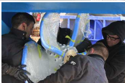
Montage de l'hélice en lieu et place de l'hélice métallique
